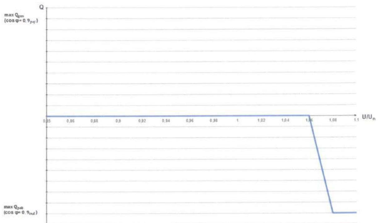
Rys.4. Charakterystyka sterowania mocą bierną w funkcji napięcia dla mikroinstalacji podłączonych jednofazowo, wymagana przez OSDn.
